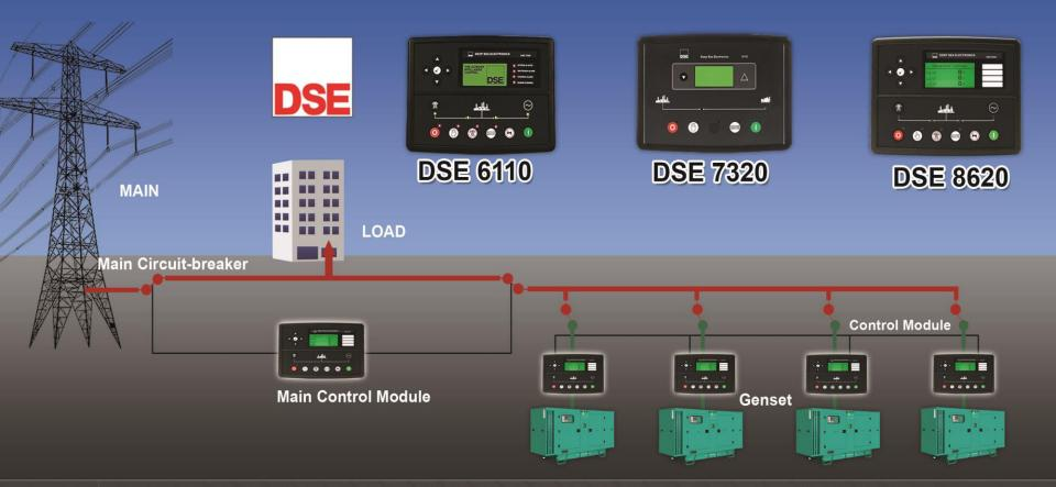
Monitoring speed, frequency, voltage, current, oil pressure, coolant temperature and fuel level, the modules will display warnings, shutdown and engine status information on the back-lit LCD screen and illuminated LED. تستخدم هـذه اللوحـات فـى قـراءة بيانـات المولـد والتحكـم فيـه وكذلـك هـى صمـام الأمـان ضــد أى عطـل يحــدث للمولـد حيـث تقــوم بإعطـاء إنــذارات أو توقـف المولـد أوتوماتيكيا فى حالة حدوث عطل طارئ.
